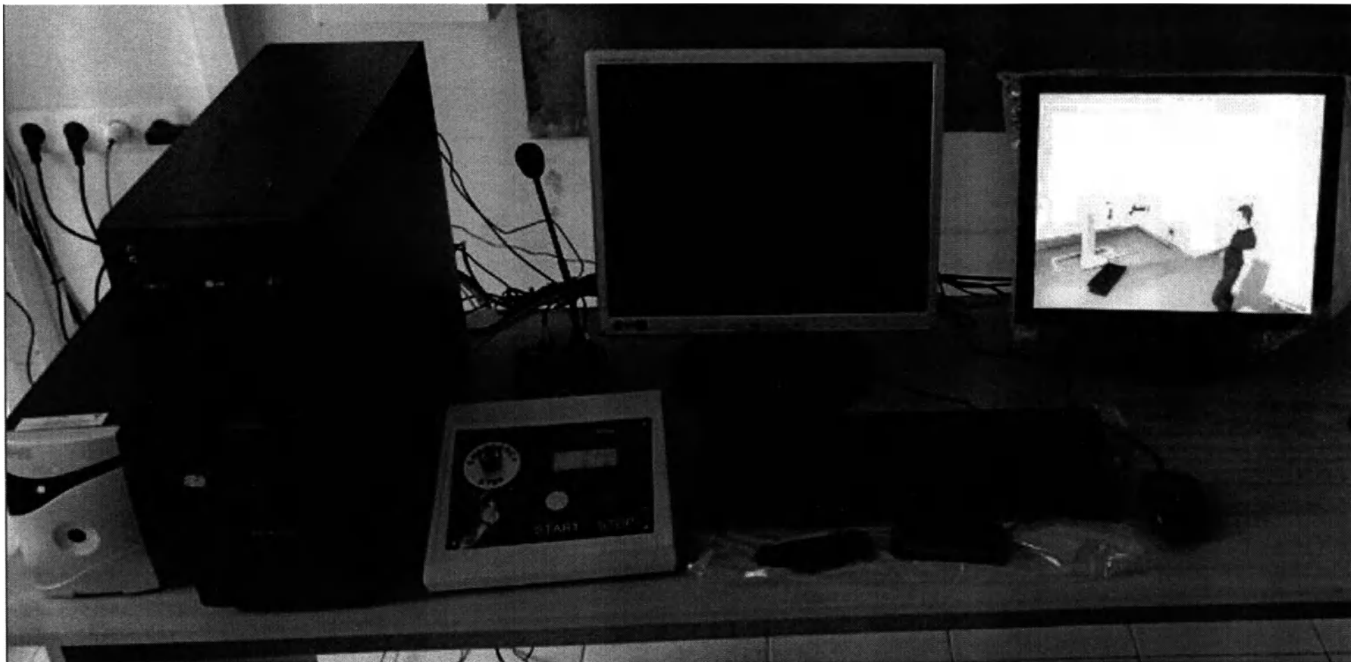
Рабочая станция управления аппаратом (компьютер управляющий, монитор, клавиатура, мышь, ИБП)
