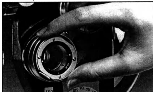
Рис. 16 - Установка кресс цилиндра для контроля силы (знаки «Р» на модуле цилиндра должны быть параллельны оси корректирующего цилиндра)
