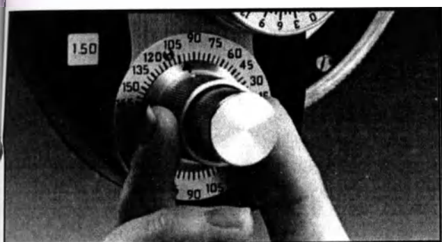
Рис.9 Настройка цилиндрической оси (внешн. Ручка)
