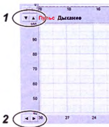
Рис. 140. Регулировка чувствительности и развёртки.
