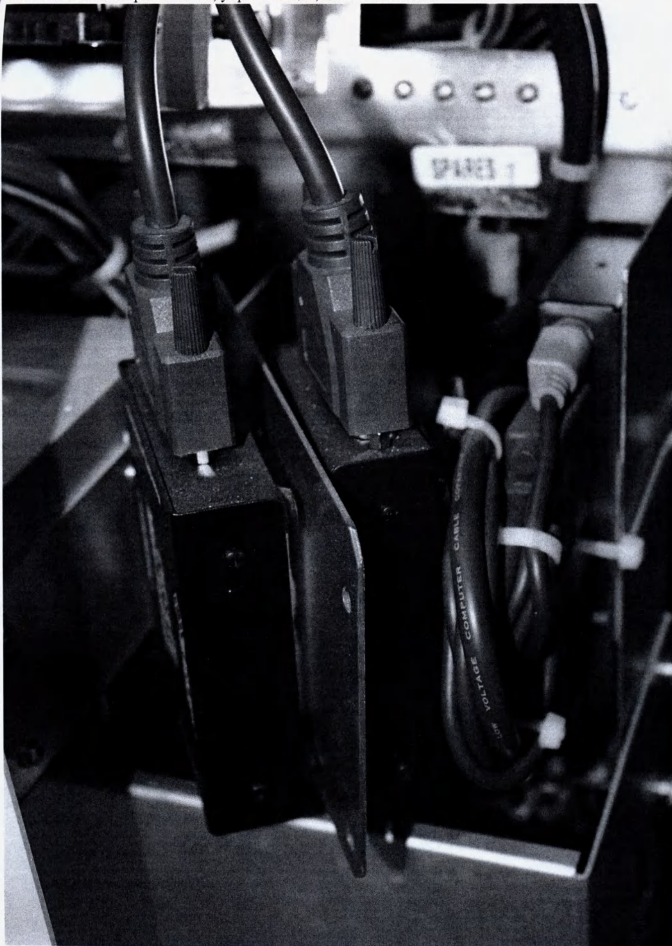
Фото 55. Коннекторы силовые, управляющие, коаксиальные
