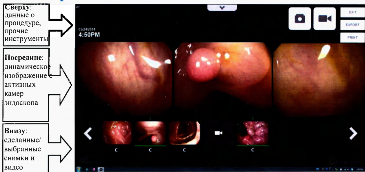
Рисунок 10. Секции пользовательского интерфейса в окне процедуры
