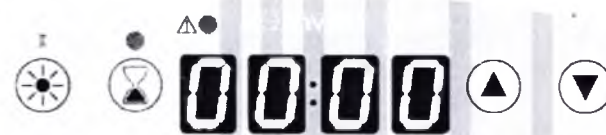
Рисунок 12 – Панель управления изделия в рабочем состоянии Пока не пройдет 59 секунд, на дисплее будет отображаться 00:00.
