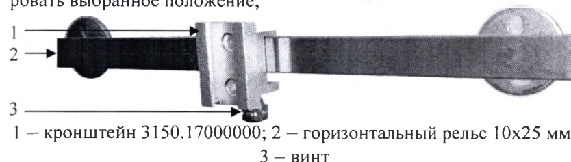
Рисунок 5 – Крепление кронштейна на горизонтальный рельс
