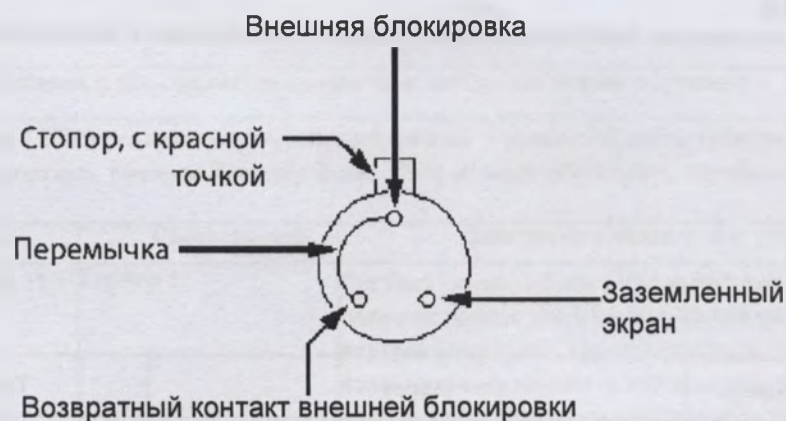
Рисунок 78. Назначение контактов внешней блокировки от двери (показана сторона пайки разъема)
