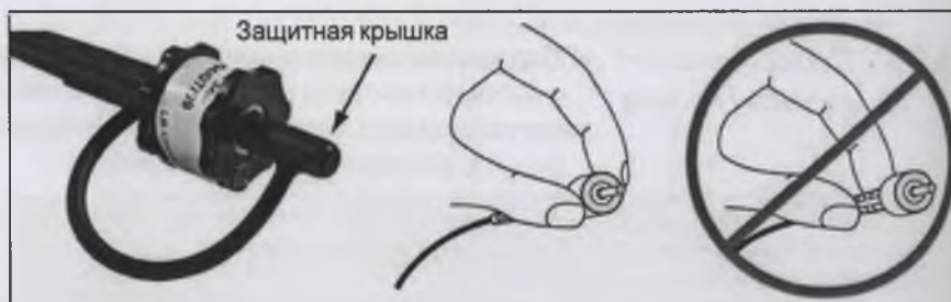
Рис. 3-8: правильное извлечение соединителя волоконного световода
