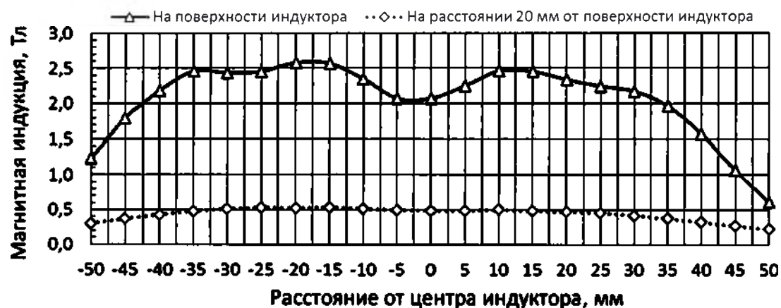
Рис. 31. График зависимости индукции магнитного поля индуктора ИД-02-50 как функции радиального перемещения для стандартного бифазного стимула (280 мкс).
