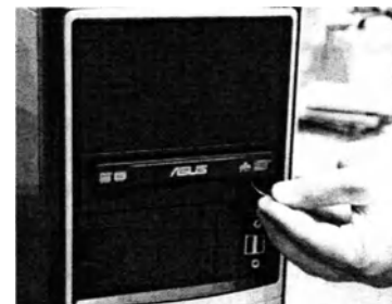
Рис. 9. Аварийное открытие лотка дисковода.
