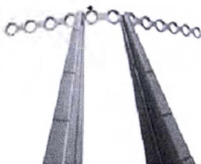
Сгибание вне плоскости пластины
