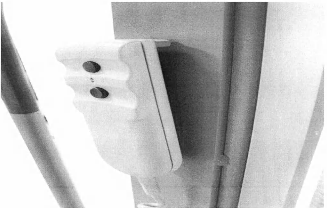
Рис. 3 – Пульт для управления подъёмом и спуском ложа Подъёмника
