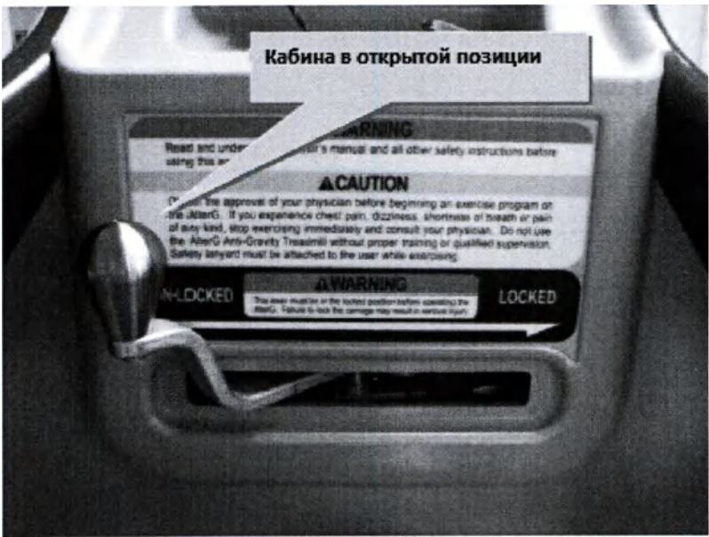
Иллюстрация 21. Замок кабины находится в открытой позиции
