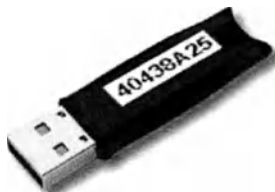
Рис. 2.8. Электронный ключ (HASP ключ)
