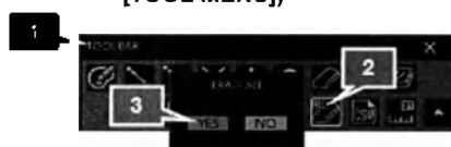
Очистка содержимого накладных элементов (через [TOOLBAR])
