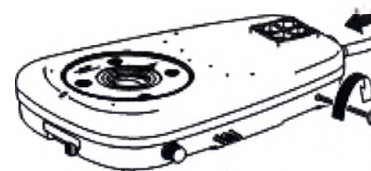
Подсоединение оптоволоконного кабеля к основанию затягивания винта
