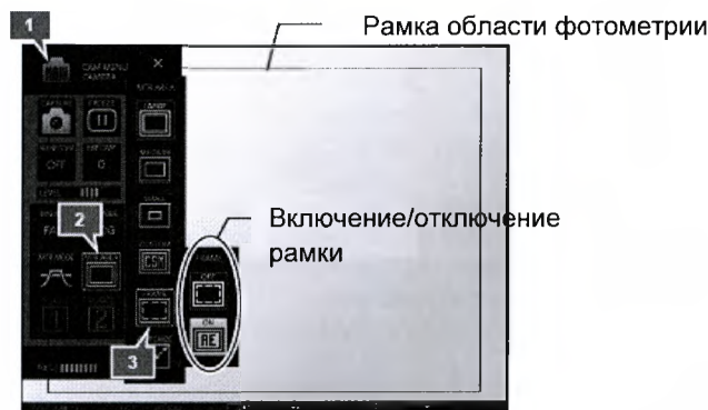
Отображение рамки области фотометрии
