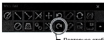
Повторное отображение отмененных результатов измерения
