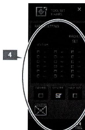
Отображение настроек для визирных линий и концентрических окружностей (окно [TOOL SET: X HAIRS])
