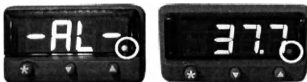
Рис. 13 – Вид дисплея контроллера температуры с тревогой о превышении температуры. Красный светодиод обведен
