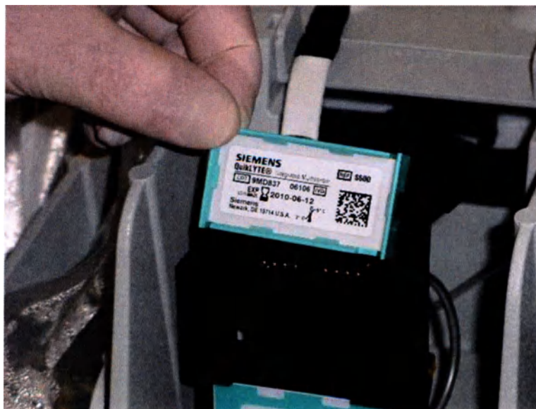
Рис. 2-20: Установка датчика QuikLYTE®
