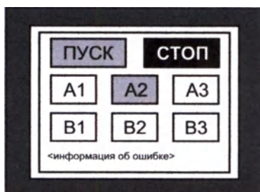
Рисунок 13. Вид экрана дисплея при возникновении ошибок в процессе работы Установки
