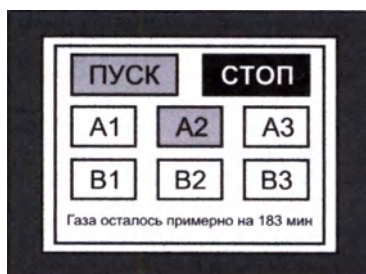
Рисунок 12. Вид экрана дисплея при плазмогенерации в режиме A2
