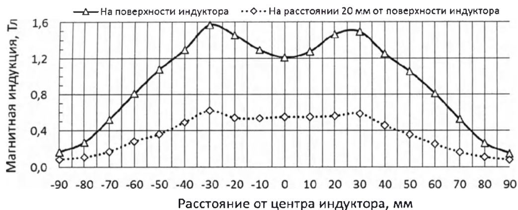
Рис. 29. График зависимости индукции магнитного поля индуктора ИДУ-02-100-О как функции перемещения вдоль прямой, соединяющей центры отверстий, для стандартного бифазного стимула (280 мкс).
