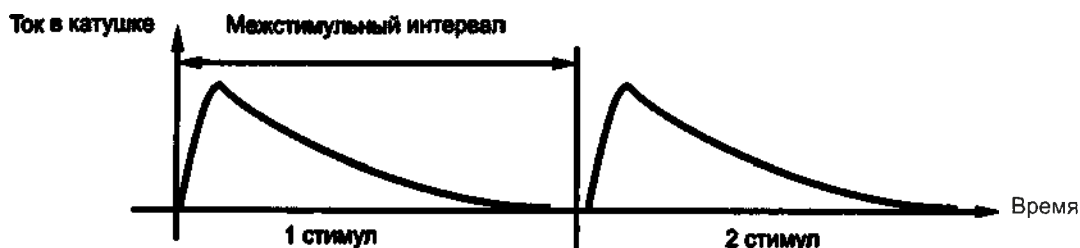
Рис. 4. Форма тока при парном монофазном стимуле.
