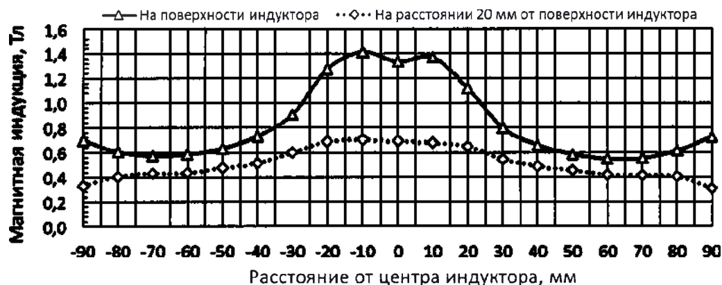
Рис. 33. График зависимости индукции магнитного поля индуктора ИДУ-02-125 как функции перемещения вдоль прямой, соединяющей центры отверстий, для стандартного бифазного стимула.
