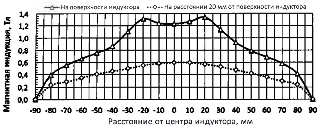
Рис. 21. График зависимости индукции магнитного поля индуктора ИК-02-150-О как функции радиального перемещения для стандартного бифазного стимула (280 мкс).
