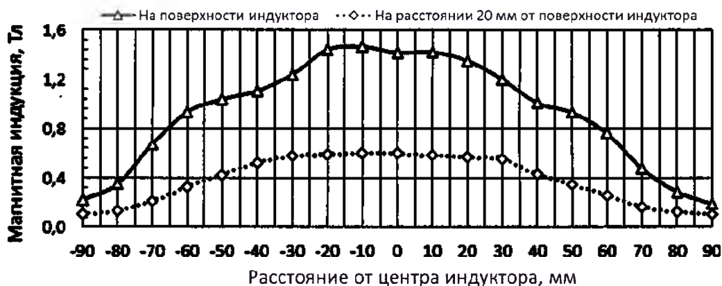
Рис. 28. График зависимости индукции магнитного поля индуктора ИДУ-02-100 как функции перемещения вдоль прямой, соединяющей центры отверстий, для стандартного бифазного стимула (280 мкс).
