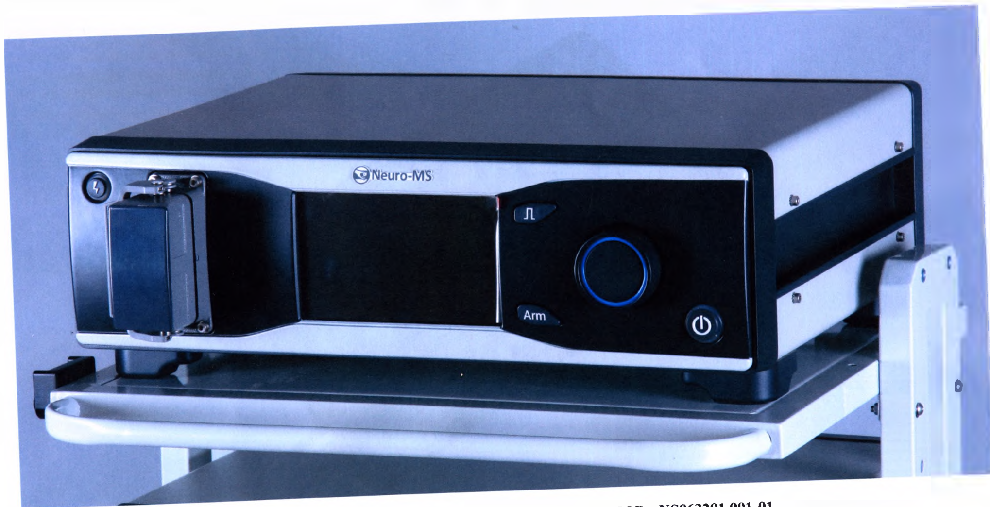
Монофазный блок магнитного стимулятора «Нейро-МС», NS063201.001-01
