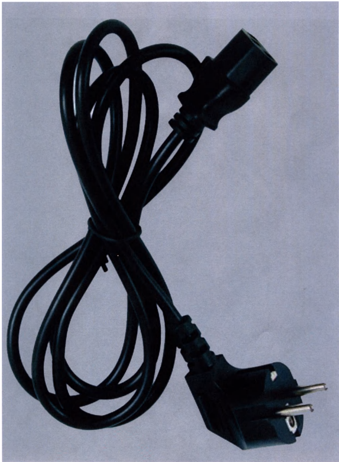
Кабель сетевой CEE 7/7 — IEC C13, 220 В, 10 А, 1.8 м (3G×0.75 кв. мм)
