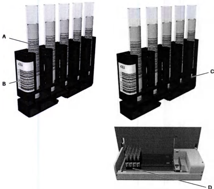
А Штрих-код образца С Резиновая прокладка В Штрих-код штатива D Штативы на лотке, который помещается в блок загрузки
