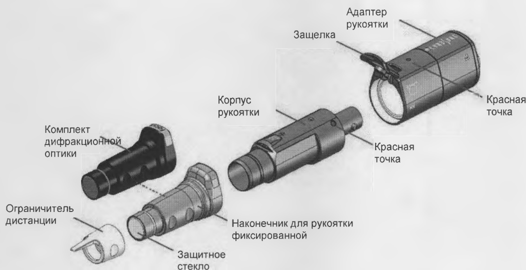
Рис. 6А. Рукоятка фиксированная, в разобранном виде
