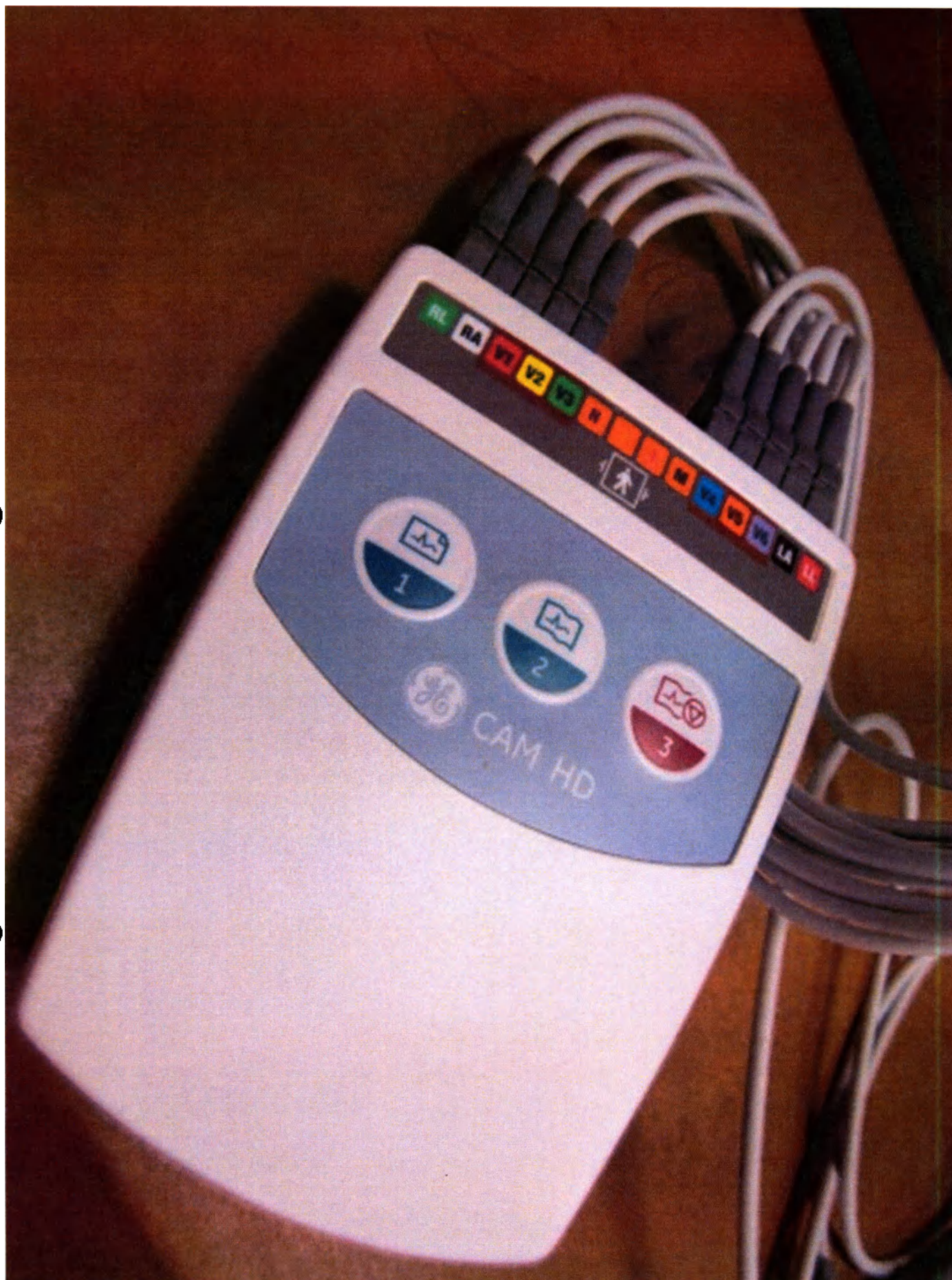
22 Модуль регистрации ЭКГ с функциями усилителя биопотенциалов и подавления помех (не более 2 шт)
