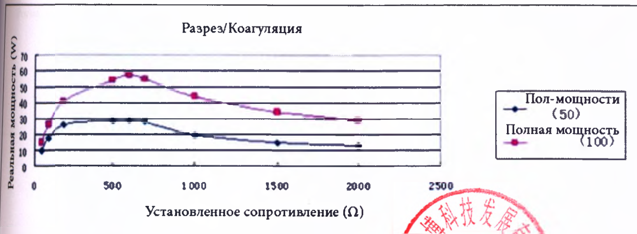
Рис.3. График демонстрирует зависимость Мощности выходного сигнала от установленного сопротивления. Форма волны сигнала при опции: Разрез/коагуляция.
