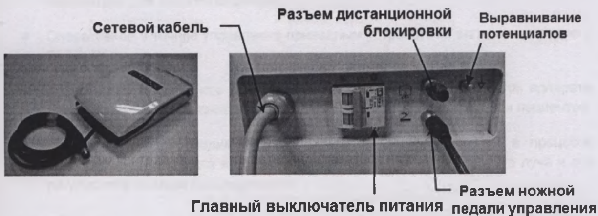
Рисунок 3.3 Педаль управления ножная и основная панель подключения электропитания аппарата
