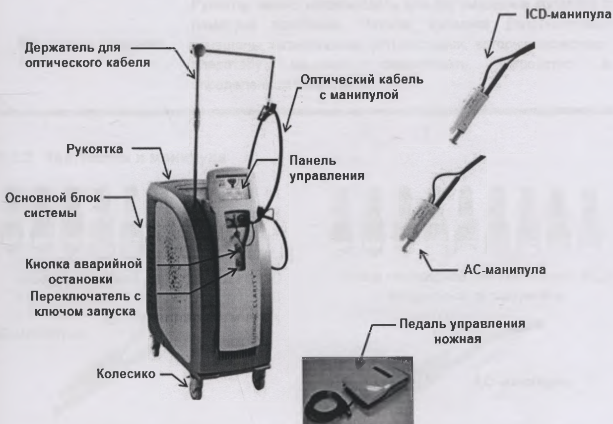
Рисунок 3.1 Внешний вид аппарата и его основные компоненты
