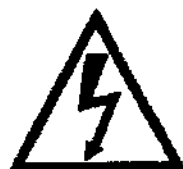
Рис. 9. Предупреждающий знак «Опасность поражения электрическим током!»
