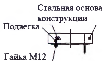
Рис. 1 Монтаж установочного блока
