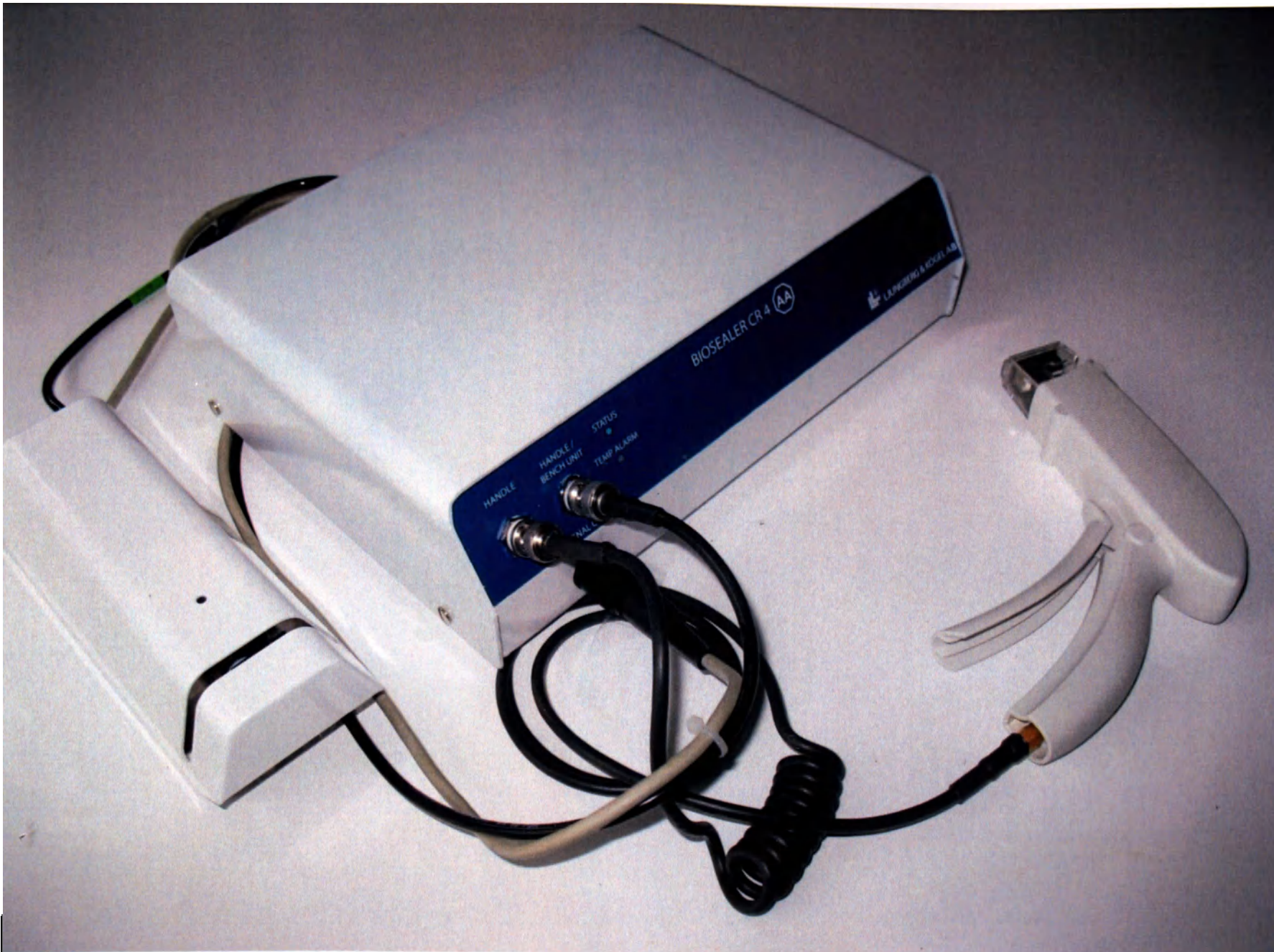
Запаиватель пластиковых магистралей, варианты исполнения: Biosealer CR4 и CR4-AA
