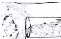
Рис. 2: Дефект неплотно заполняется шариками Syntriker® Ceraball® , диаметр шариков составляет 4 мм и 6 мм.
