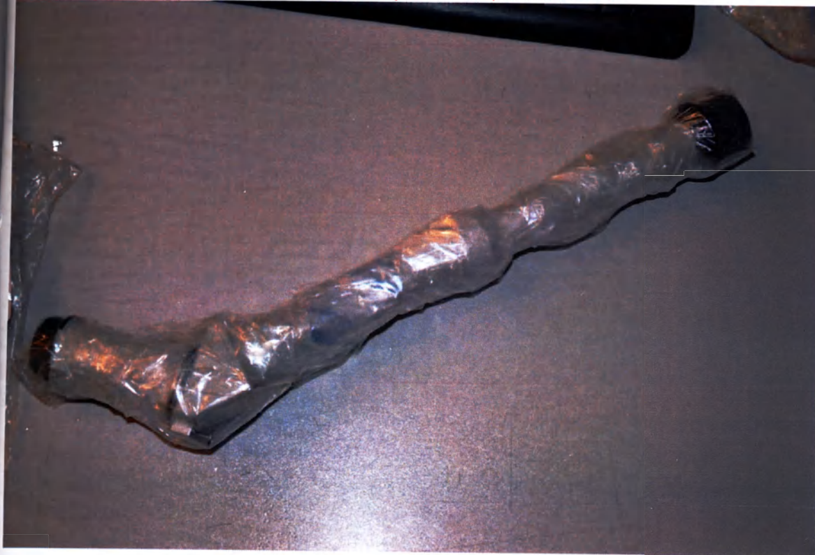
Наблюдательная труба ассистента сталь марки AISI 430,оптика стекло
