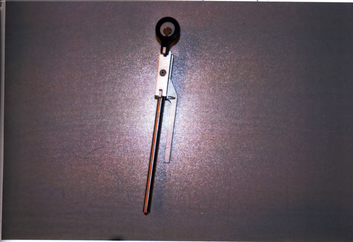
Наблюдательная труба ассистента сталь марки AISI 430,оптика стекло
