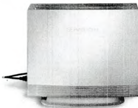
Рисунок 7-12 Зарядная корзина для детектора
