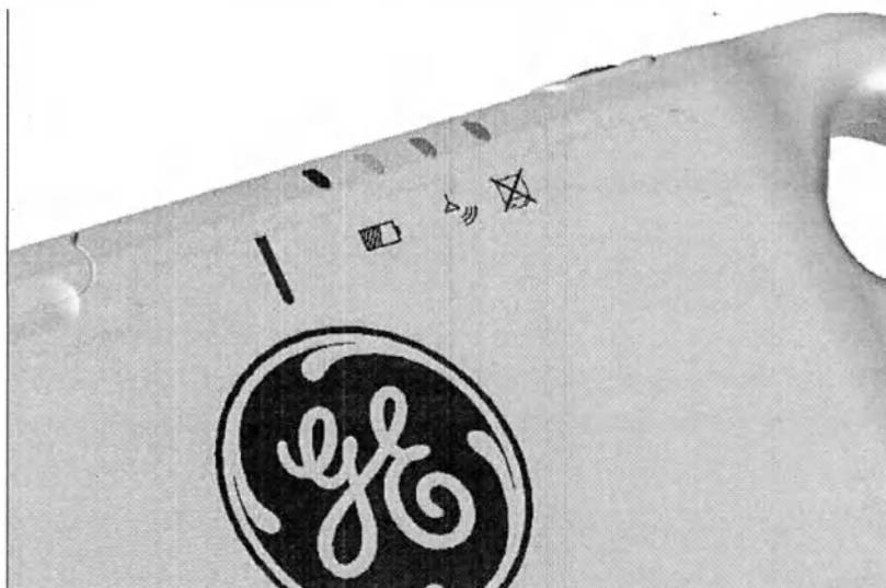
Рисунок 7-21 Осталось 1—24 % заряда батареи; беспроводная связь подключена; детектор готов к работе
