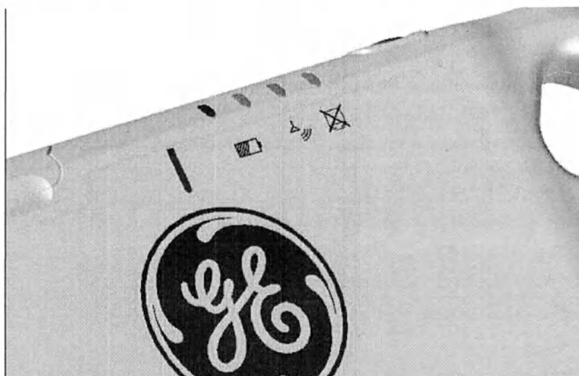
Рисунок 7-20 Осталось 25—49 % заряда батареи; беспроводная связь подключена; детектор готов к работе
