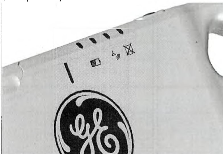
Рисунок 7-25 Детектор в неисправном состоянии
