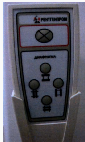
Рисунок 10.2 – Пульт дистанционного управления диафрагмой в металлической кабине
