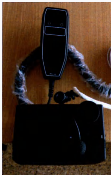
Рисунок 9 – Пульт дистанционного управления подъемником в металлической кабине
