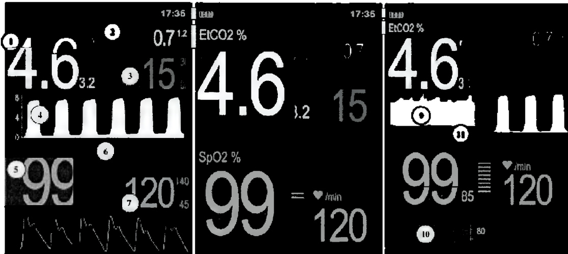
Дисплей 3-5: Тренды (15 минутный, 1 часовой 6 часовой тренды, одновременно с измерениями в режиме реального времени)
