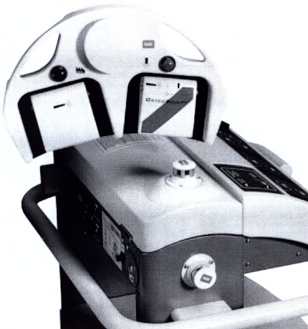
Рис. 3-6: Беспроводная педальная панель и встроенные ИК-приемники наверху и слева на консоли
