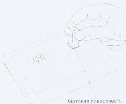
Рис. 4. Установка оптической кюветы
