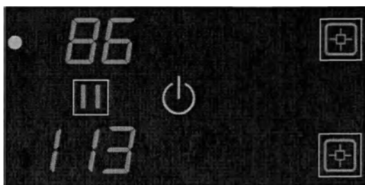
Рисунок 1: Экран дисплея: нормальное состояние, обработка задания печати из верхнего устройства подачи. В данном примере в верхнем картридже уложены 86 листов пленки и в нижнем картридже – 113 листов.
