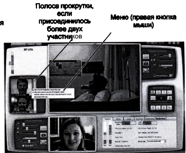
Контрольная станция ведущего сеанса множественного присутствия На контрольной станции ведущего активны средства локального, дистанционного и расширенного управления, а также джойстик.
