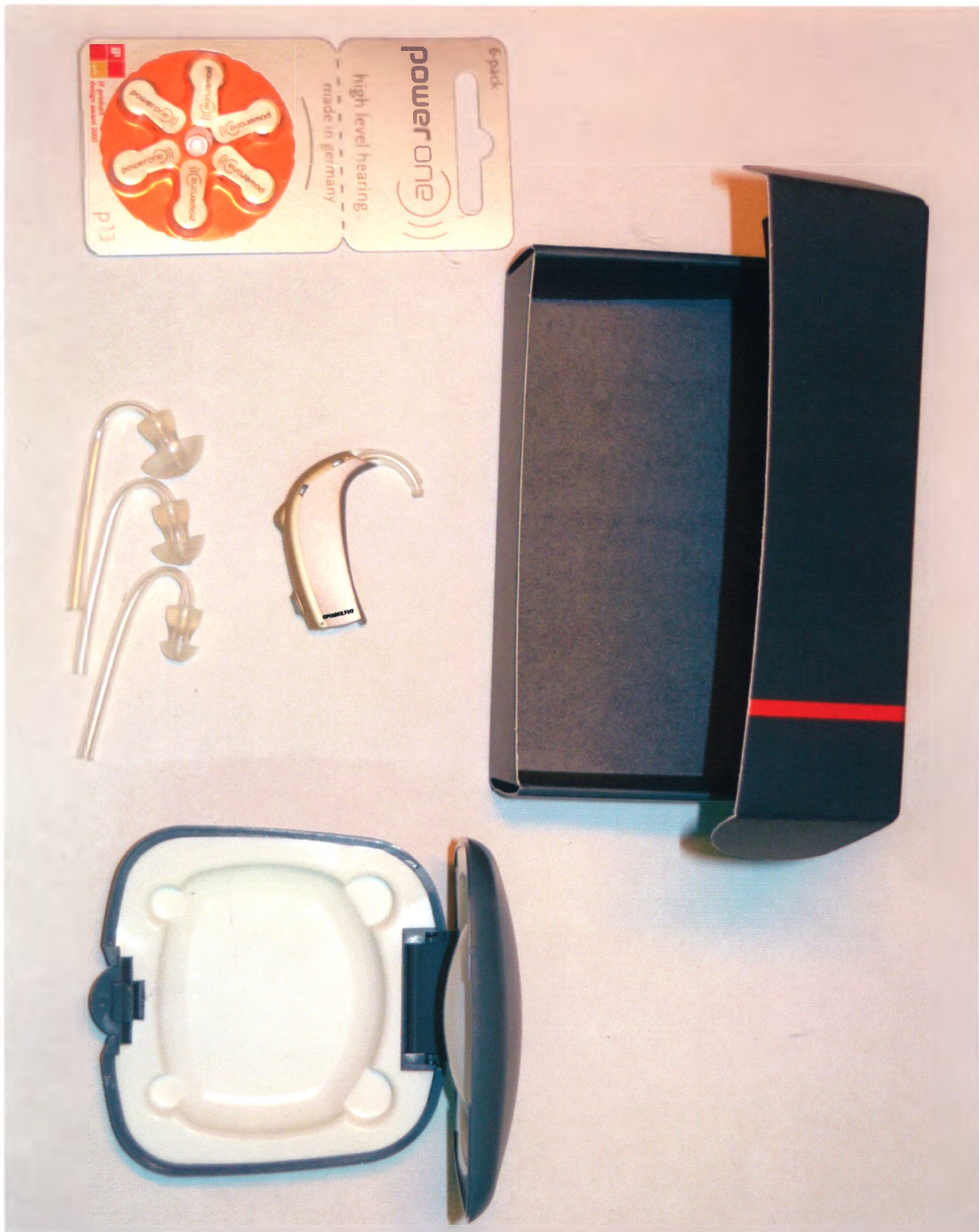
ФОТОГРАФИЯ АППАРАТА СЛУХОВОГО ЦИФРОВОГО ПРОГРАММИРУЕМОГО «ПРЕМИА PH7» С ПРИНАДЛЕЖНОСТЯМИ : ЗВУКОПРОВОД №1, №2, №3; ЭЛЕМЕНТ ПИТАНИЯ 1,4 В, ТИП 13; ФУТЛЯР; КОРОБКА.
