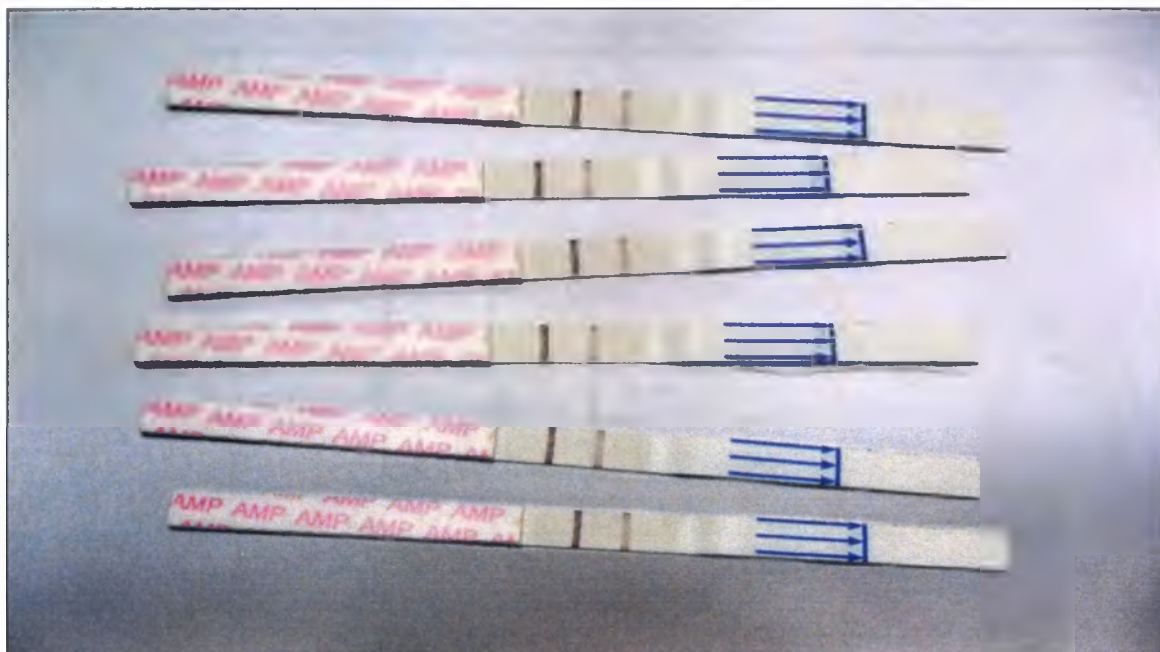
Рисунок 7. Фоторегистрация испытаний чувствительности тест-полоски "ЭКСПРЕСС-ТЕСТ-АМФЕТАМИН-МП БИО" погружного типа на аналитическом стандарте мочи (negative).
