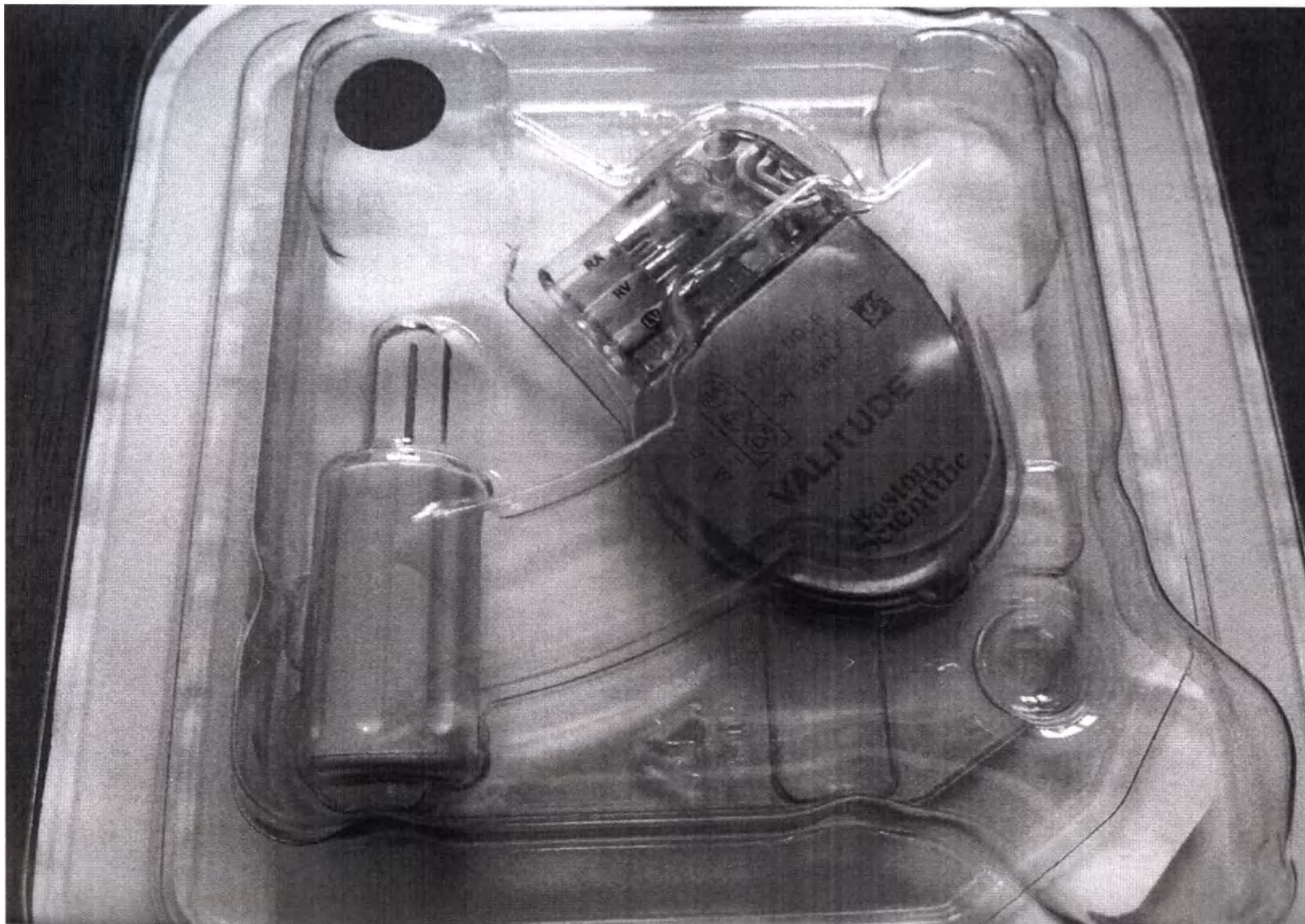
Содержимое стерильной упаковки: кардиостимулятор и отвёртка
