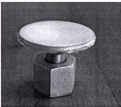
Рисунок 13. Общий вид фильтр грубой очистки
