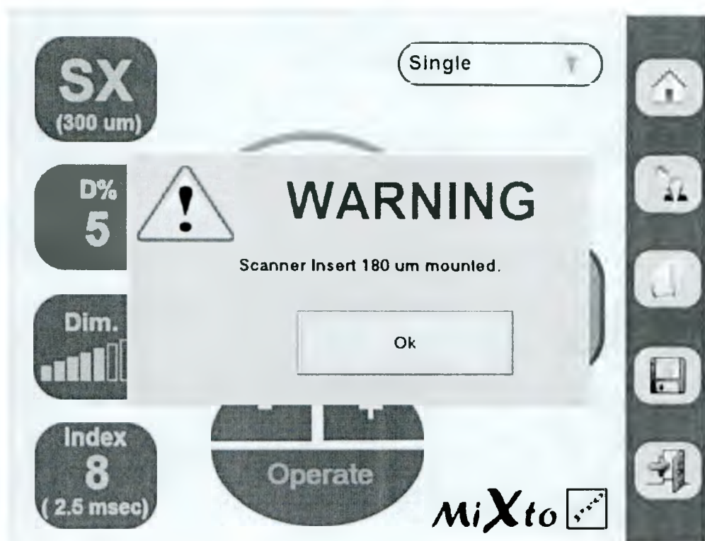
Рис. 65. Режим “SX”– В наконечник сканирующий правильно вставлена насадка 180 мм.
