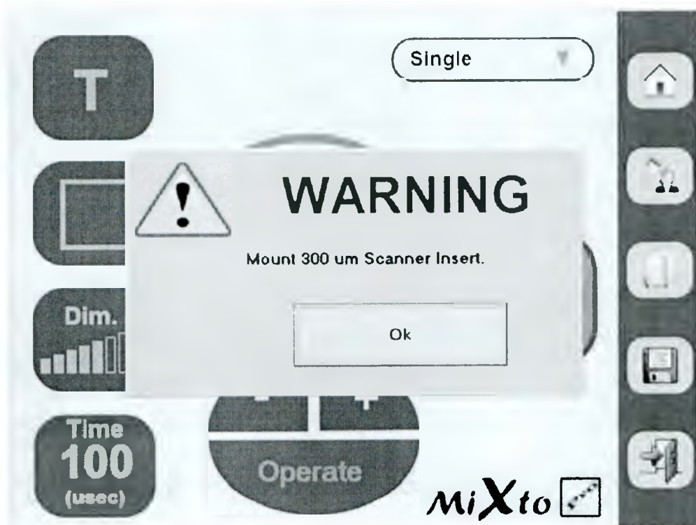
Рис. 66. Режим “Т”– запрос установить насадку 300 мкм на наконечник сканирующий.
