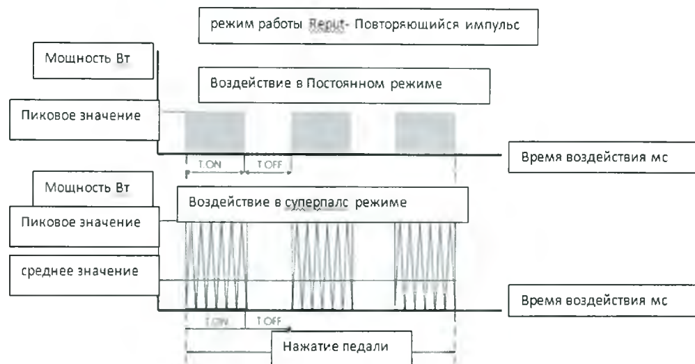
Рис. 20. Типы экспозиции в режиме “REPEAT” (Повторяющиеся импульсы).
