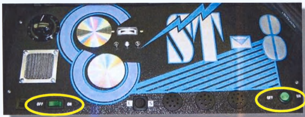
Главный выключатель электропитания
