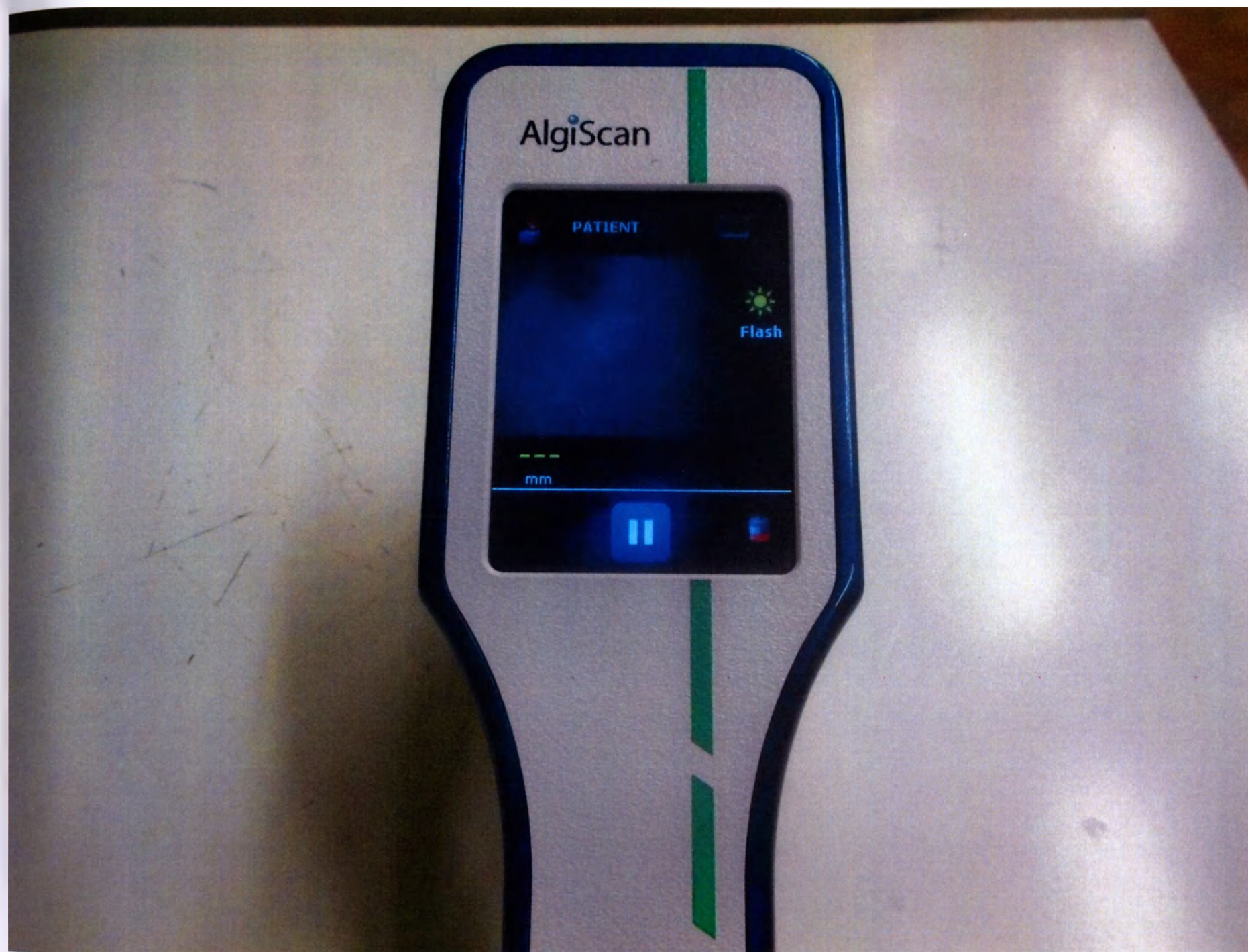
Видеопупиллометр для мониторинга анальгезии AlgiScan
