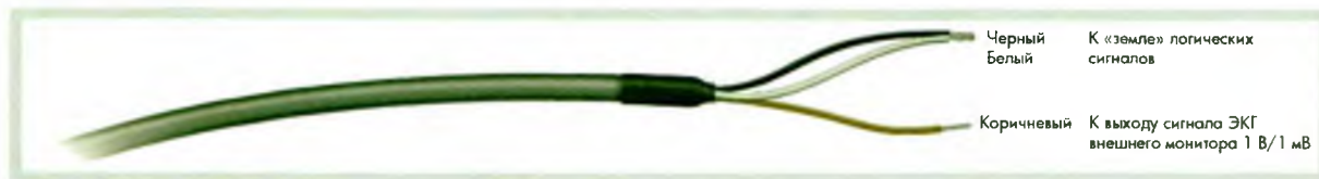
Рис. 5-1: Кабель внешнего сигнала ЭКГ
