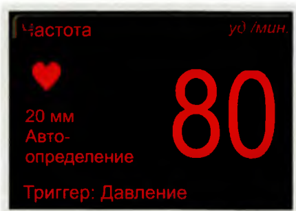
Рис. 1-5: Пример источника триггера «Давление»
