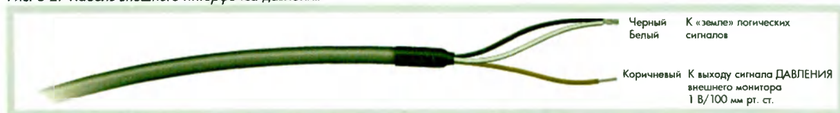
Рис. 5-2: Кабель внешнего интерфейса давления
