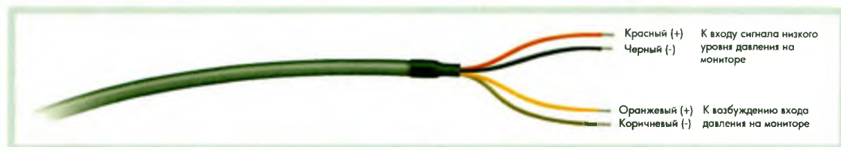
Рис. 5-3: Кабель интерфейса выхода давления низкого уровня
