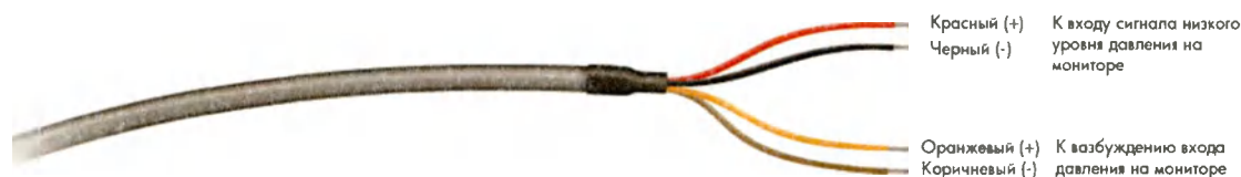
Рис. 5-3: Кабель интерфейса выхода давления низкого уровня
