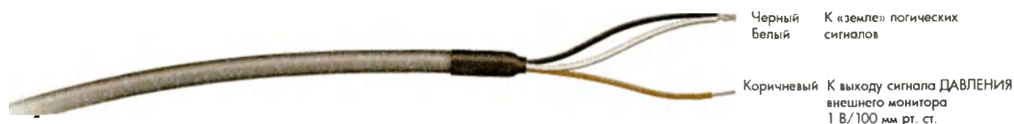
Рис. 5-2: Кабель внешнего интерфейса давления
