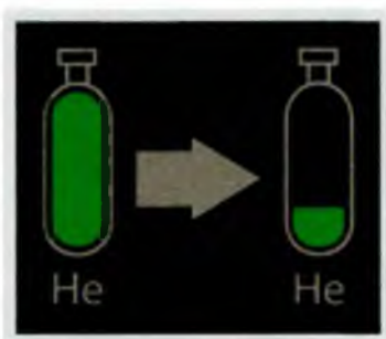
Рис. 1-18: Пример изменения индикатора гелия с полного резервуара до почти низкого уровня
