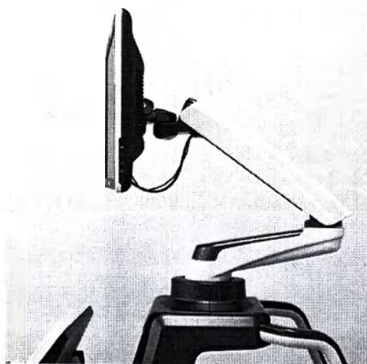
Рис.4-9. Завершение установки несущего рычага и ЖК-монитора
