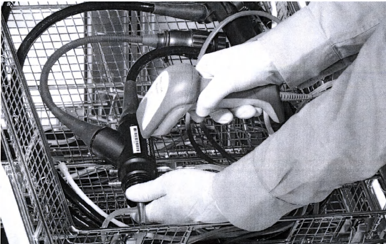
Работа со сканирующим устройством в машинах INNOVA серии CMS для гибких эндоскопов с системой мониторинга каналов.
