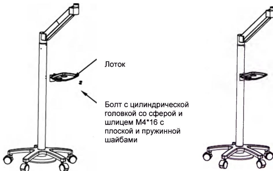
Монтаж наклонной части стойки
