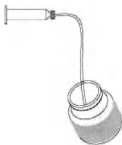
заполнение посредством трубки для заполнения
