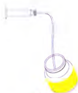
заполнение посредством трубки для заполнения
