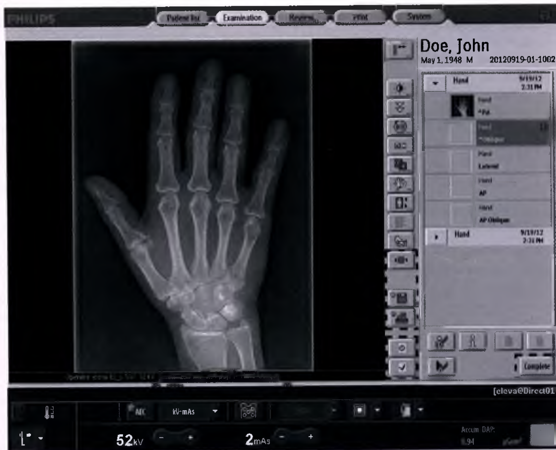
Рис. 7: Раздел «Examination» (Исследование) со встроенной панелью управления генератором
