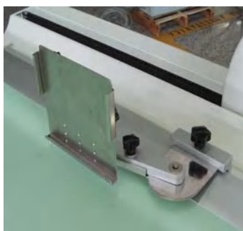
Кассетодержатель для съемок в боковой проекции
