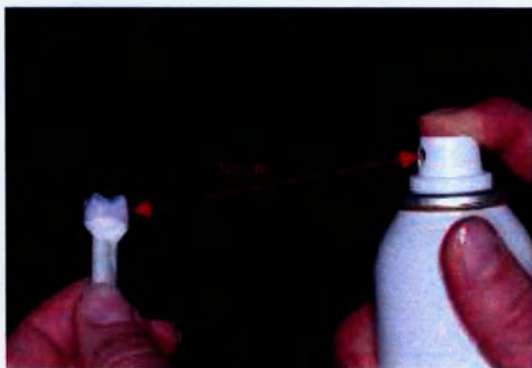
Удерживайте реставрацию за штифт для обжига IPS e.max CAD Crystallization Pin
