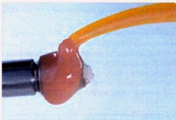
Virtual Extra Light Body Fast Set наносится на Ti базу...
