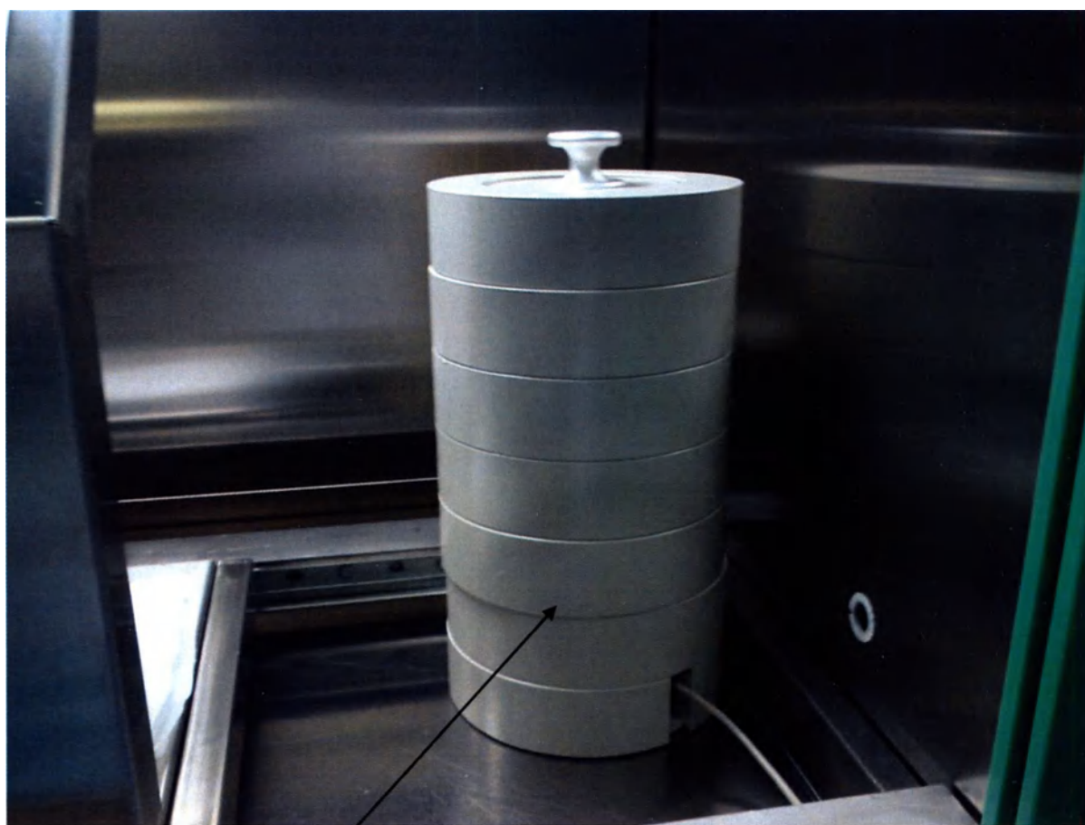
Дополнительная защита от излучения с энергией 511 кэВ для ионизационной камеры
