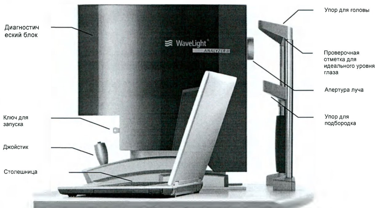
Рисунок 4: Общий вид системы офтальмологической WaveLight Analyzer II (вид сбоку)
