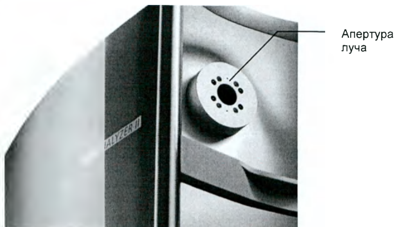
Рисунок 2: Система офтальмологическая WaveLight Analyzer II (вид со стороны пациента)
